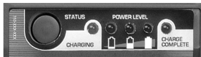
Figure 2. Bouton de test, voyants de charge en cours, de niveau de charge et de charge terminé.
